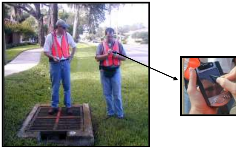
شکل ۴-۹- نمونه ای از فهرست برداری از املاک و دارائیهای شهر از طریق ساج همراه
